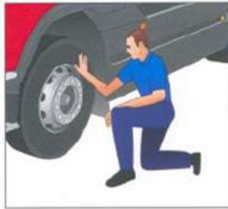
ภาพที่ 3.27 ตัวอย่างการตรวจสอบความพร้อมบริเวณด้านซ้ายล้อหน้าของยานพาหนะ
