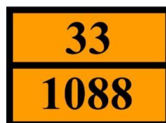
ภาพที่ 6.32 ตัวอย่างป้ายสีส้มที่มีหมายเลขแสดงความเป็นอันตราย และหมายเลขสหประชาชาติของวัตถุอันตราย โดยส่วนบนของป้ายกำหนดเป็นหมายเลขแสดงความเป็นอันตราย และส่วนล่างของป้ายกำหนดเป็นหมายเลขสหประชาชาติของวัตถุอันตราย
