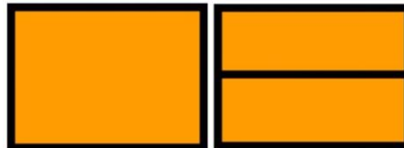
ภาพที่ 6.31 ตัวอย่างป้ายสีส้มที่ไม่มีข้อความ เป็นป้ายสี่เหลี่ยมพื้นสีส้มสะท้อนแสง มีเส้นขอบสีดำ หรืออาจมีเส้นแนวนอนสีดำคั่นที่กึ่งกลางของป้ายก็ได้
